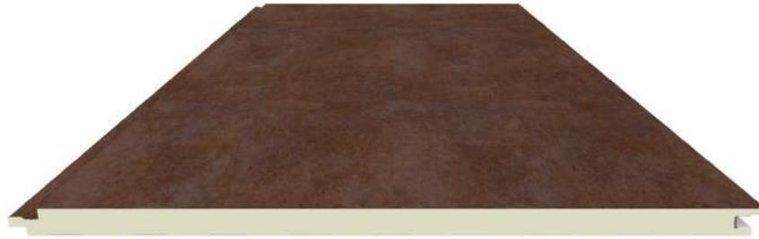
Panel sándwich de fachada acabado **imitación acero corten** de 35mm de espesor con tornillería oculta. Este tipo de panel es ideal para utilizar en construcciones que requieren un acabado estético más bien arquitectónico. Imita los tonos oxidados del acero corten pero evitando las típicas manchas que este acero genera una vez instalado. Además obtenemos las propiedades aislantes del panel sándwich.
