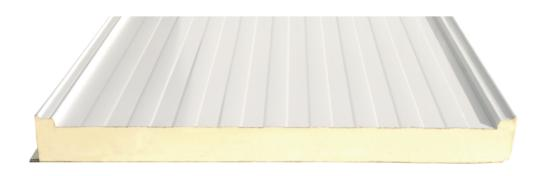
El panel sándwich para cubierta a **2 grecas** con tornillería oculta posee un sistema machihembrado y con colocación de tapajuntas que le otorgan el máximo grado de estanqueidad y durabilidad de las juntas. Las caras exteriores están fabricadas en acero prelacado mientras que el núcleo del panel es de espuma PUR lo que le otorga clasificación al fuego **Bs2d0.**
