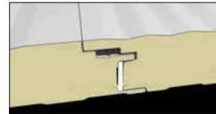
Panel sándwich de fachada de 40mm de espesor con acabado liso exterior y un tipo de instalación con tornillería oculta. Este tipo de panel confiere un alto acabado estético y se utiliza principalmente en edificios industriales o comerciales. Permite la instalación tanto de tipo vertical como horizontal.
