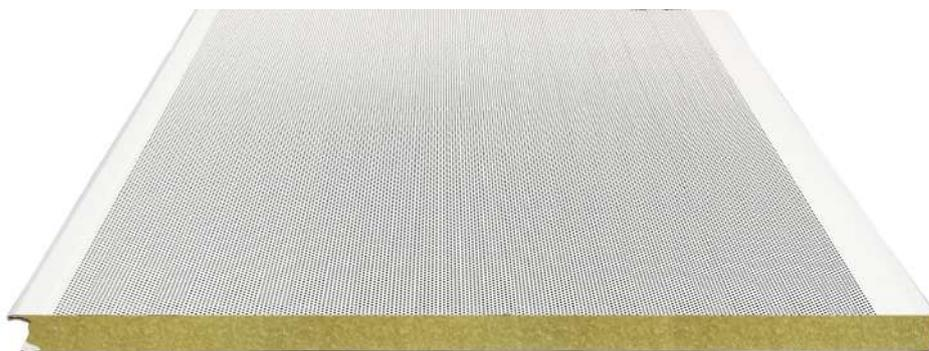
El panel sándwich para fachada **Lana de Roca acústico** se compone de dos chapas de acero y un núcleo de Lana de Roca en el centro, con la particularidad de que la cara interna del panel está perforada. Esto aporta propiedades acústicas al panel: aislamiento y absorción sonora.
