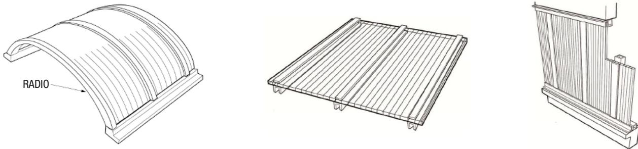
\*El policarbonato celular puede ser curvado en frío instalándolo sobre perfiles de soporte curvos. Las placas deben doblarse longitudinalmente, nunca a lo ancho. R mínimo 900mm.
