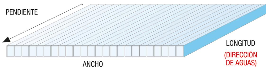
**ORIENTACIÓN DE LA PLACA.** Los nervios deben ir, siempre, en la dirección de la pendiente. (Para facilitar la evacuación del agua que se pudiera generar por condensación)
