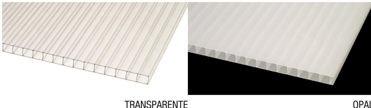
Policarbonato celular de 10mm de espesor para uso interno y/o externo. Se puede colocar tanto en fachadas como en cubiertas. Posee protección UV en ambas caras y garantía por 10 años.
