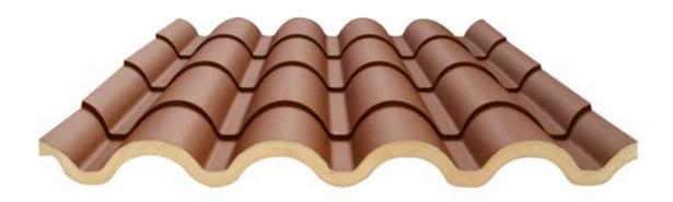
El panel teja sándwich Eco 25mm se compone de una chapa de acero pre-lacado en la parte superior y una lámina de aluminio gofrado en la parte inferior, entre ambas un núcleo de espuma rígida inyectado entre las dos hojas en un proceso de fabricación continua (PUR) de 25mm de espesor. Está especialmente indicado para doblar cubiertas de chapa grecada, tégola, uralita y tejados en mal estado, ya que la parte inferior del panel no cumple una función estética.
